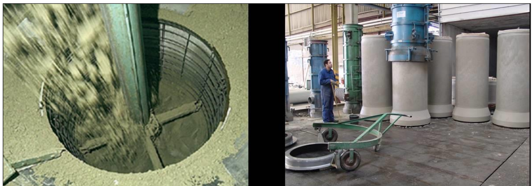
Figuur 2.6 Vervaardiging van betonproducten, gebruik makend van 'groene sterkte'
